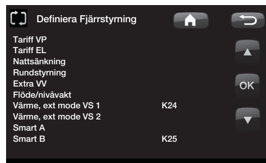
Exempel där "Värme, ext mode VS1" har tilldelats plint "K24" för fjärrstyrning
